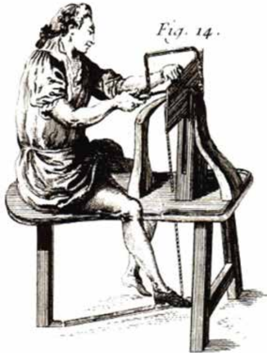
Chevalet de marqueteur au XVIII e siècle L'art du menuisier-ébéniste , par M. Roubo fils, 3 e section de la 3 e partie de L'Art du menuisier , par Roubo, André Jacob 51739-1791, Saillant et Nyon (Paris), 1774, p. 292
